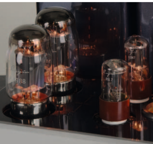
EINE RÖHRE, MEHRERE INTERPRETATION: Die große KT88 auf der Front kann wahlweise als Tetrode oder Triode erklingen.
