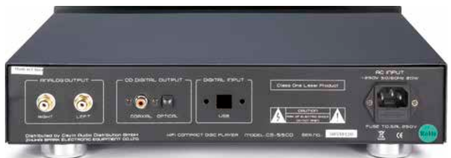
▲ Der Analogausgang führt über eine 12AU7-Röhre (Doppeltriode), digital geht es optisch oder koaxial hinaus. Der USB-Anschluss für den PC ist optional beim Kauf für rund 150 Euro bestellbar.
