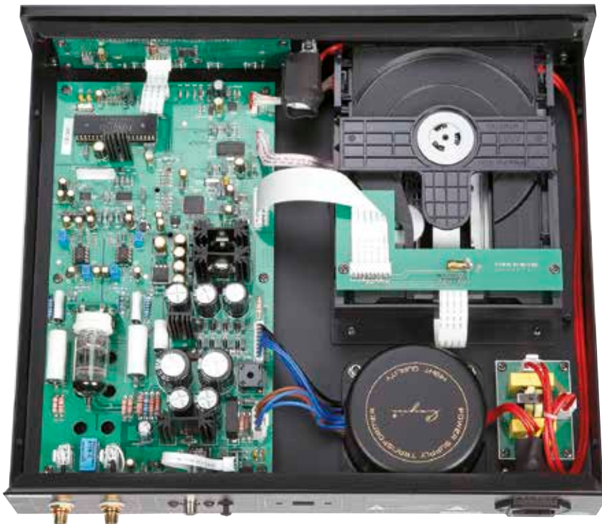
▲ Die Röhre ist liegend implementiert. Aufbau, Laufwerk, Mechanik und Stromversorgung machen einen sehr guten Eindruck.
