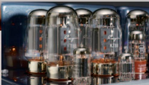
Diese Ultralinear-Technik vereint die Leistungsfähigkeit des Pentoden- mit der Verzerrungsarmut des Triodenbetriebs. Bei richtiger Auslegung der Übertrageranzapfung (für die KT88 sind das 43 Prozent der primären Übertragerwicklung) fällt der Klirrgrad auf ein Minimum ab, während die
